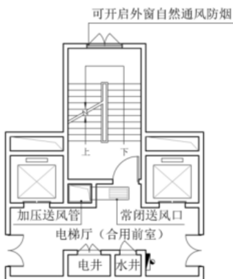
附图 9.1.4-1 加压送风不合理布置示意（一）
