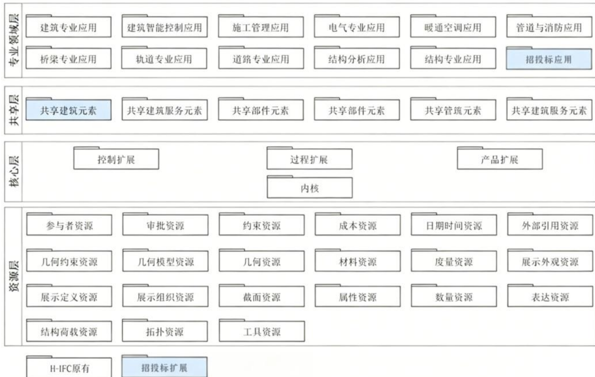
图 C.1.1 H-IFC 数据模式的整体结构
