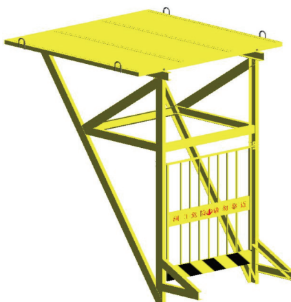
图 29 电梯井三脚架支撑型操作平台
