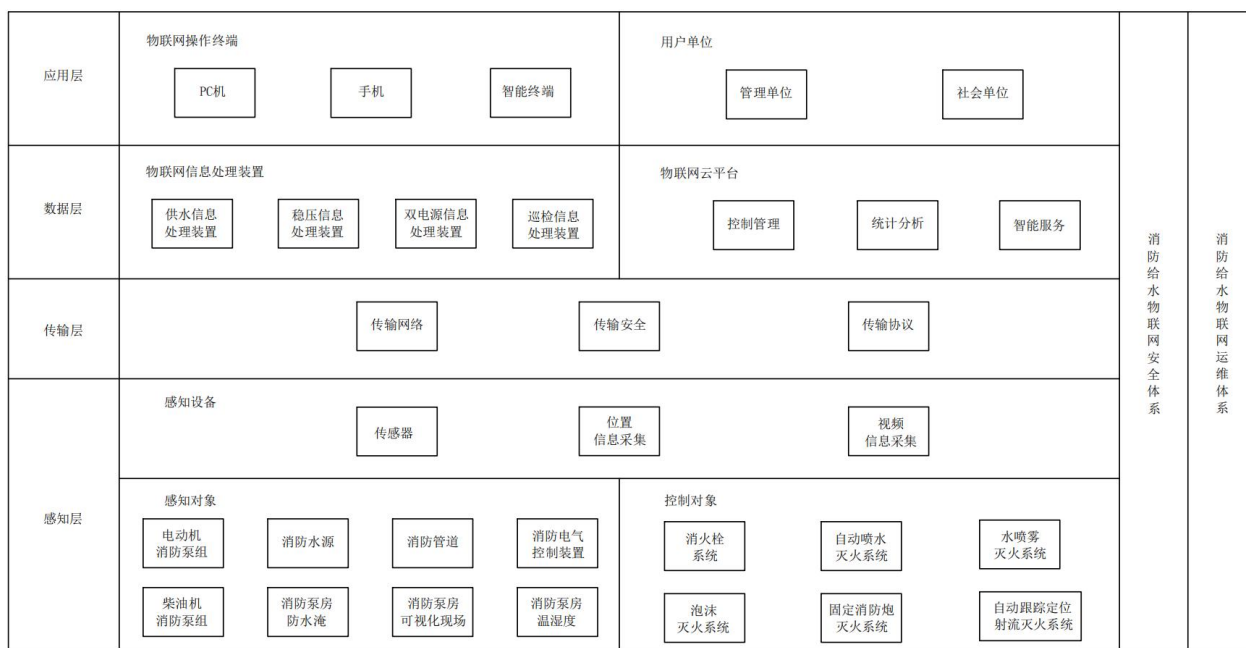
图 1 消防给水系统物联网控制技术架构图
